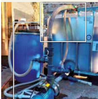
Aéroflot: outil de préparation de tisane de compost
